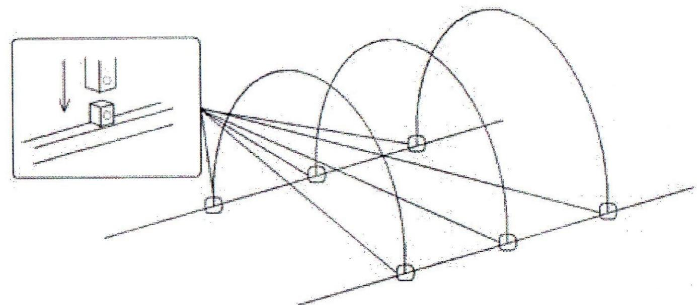
После затяжки винтов, их головка была утоплена в трубу и не выступала над ее поверхностью более чем на 1-1,5 мм.
